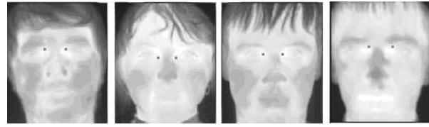
Рис. 6 Результат работы алгоритма автоматического выделения области лица
