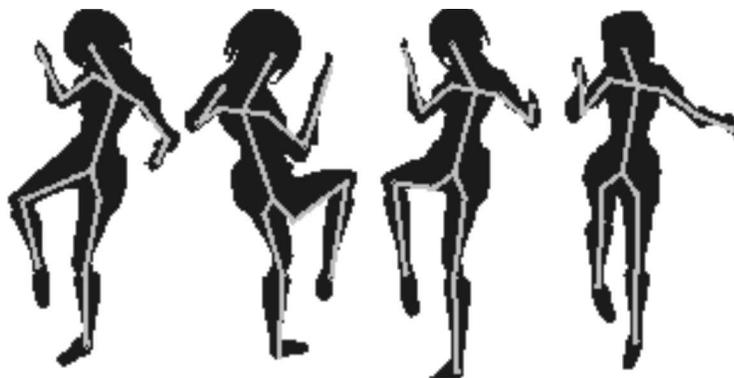
Рис. 9 Полученная шарнирная модель в разных ракурсах
