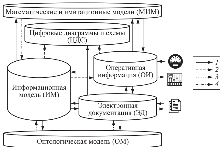
Рис. 1 Типовая архитектура ЦД: 1 — предоставление данных; 2 — привязка данных; 3 — генерация структуры; 4 — верификация
