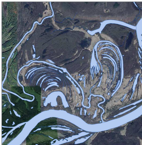
Рис. 4 Результаты автоматического дешифрирования объектов гидрографии на спутниковом изображении (из [16])
