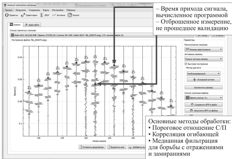
**Рис. 2** Запись сигналов приемных элементов сейсмокосы при излучении одной серии импульсов (приближен участок записи каналов 138–168, только четные каналы)
