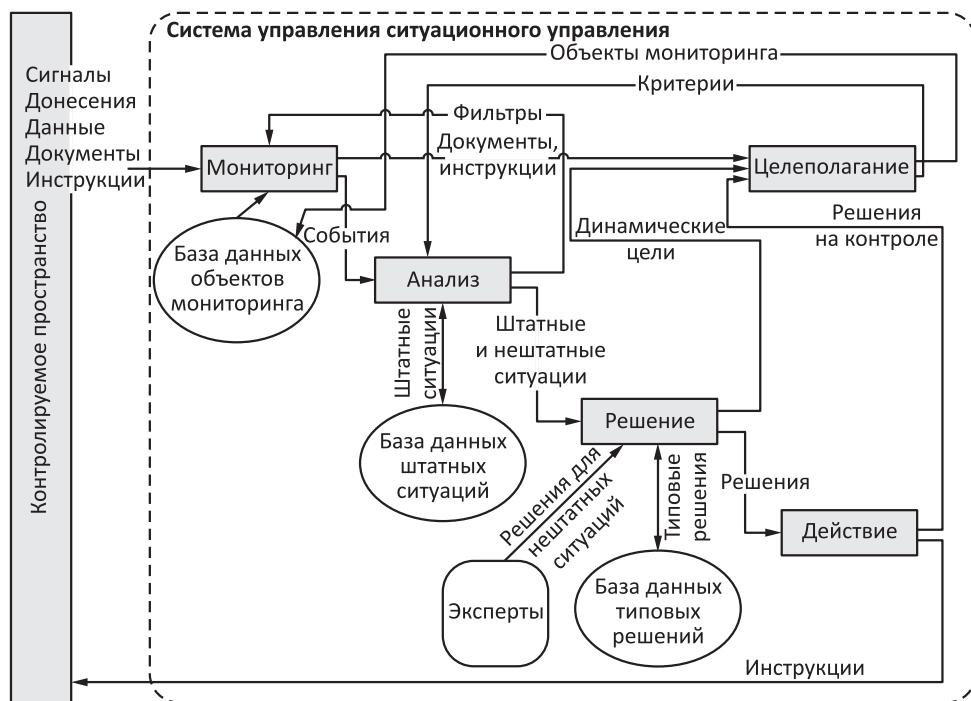
Рис. 2 Функциональная модель ситуационной системы управления
