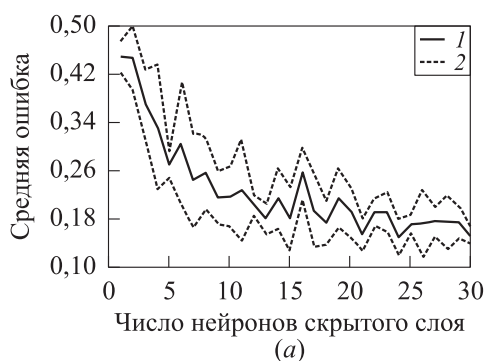
Рис. 13 Ошибки предсказания остаточного сопротивления яхты: (а) нейронная сеть и символьная регрессия; (б) нейронная сеть; 1 — ошибка; 2 — отклонение
