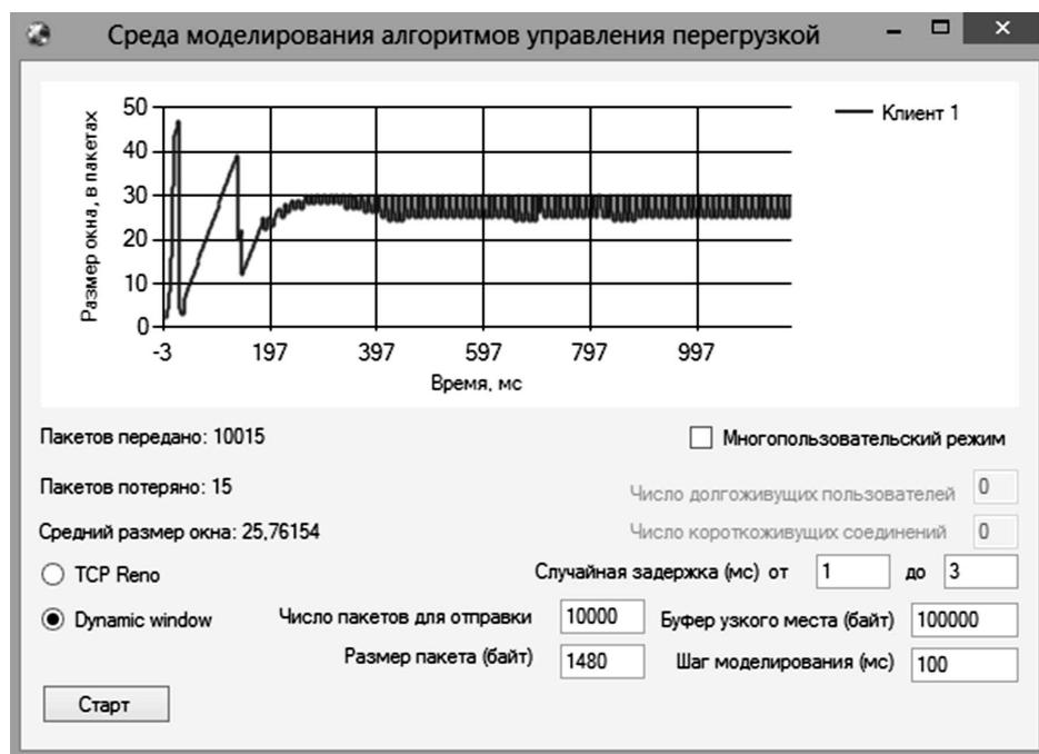
**Рис. 1** Внешний вид среды моделирования алгоритмов управления перегрузкой при исследовании способа управления доставкой пакетов на стороне получателя (Dynamic window)
