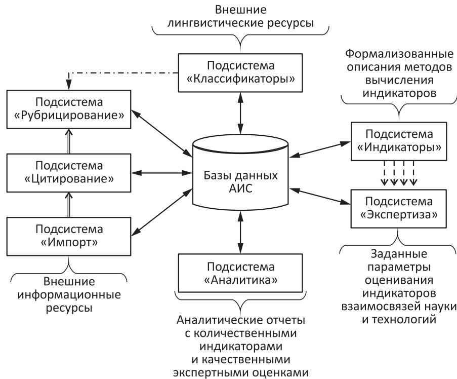
**Рис. 2** Архитектура АИС
